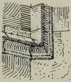
Fig. 47. Hauptkirche, Gurtgesims, mit Rundstab-Überschneidung.
